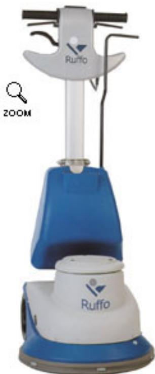
*Le monospazzole Ruffo con trasmissione ad ingranaggi, sono adatte per essere impiegate per operazioni di pulizia di fondo e manutenzione anche delle più gravose. Le versioni con ingranaggi in acciaio sono particolarmente dimensionate per effettuare lavori pesanti e specifici quali il ripristino e la cristallizzazione del marmo.*
